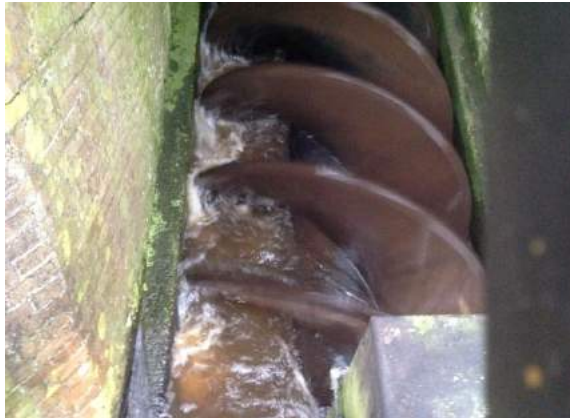
De houten vijzel of schroef waarmee Grevensmolens het polderwater opmaalt
